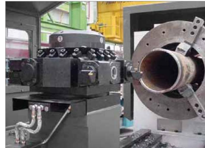
Cabezal con doble motor. Eje C con precisión 0,001°.
