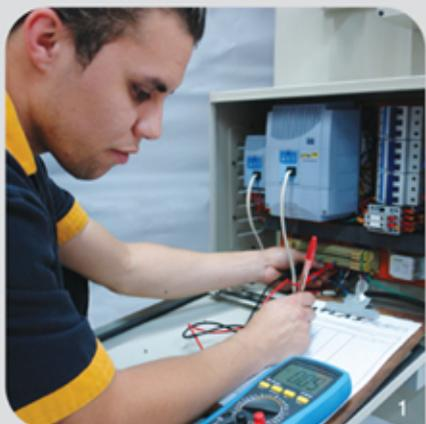
1. O teste dos itens elétricos da máquina são executados antes e depois da produção, como testes de resposta de comando, testes de resistência a alternadas correntes, potência e muitos outros.
