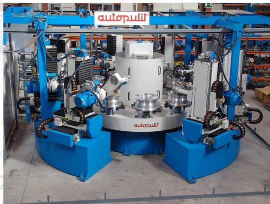
Máquina rotativa transfer CNC de 8 cabezales con 42 ejes interpolados para el pulido de ruedas de aluminio
