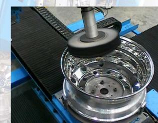
Máquina rotativa transfer CNC de 5 cabezales con 26 ejes interpolados para el pulido interior de ruedas de aluminio de camiones
