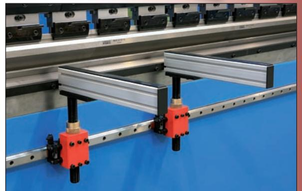
**Opcionalmente**, se pueden instalar **soportes delanteros**, los cuales facilitan el apoyo de la chapa. Son fácilmente regulables, en altura y longitudinalmente.
