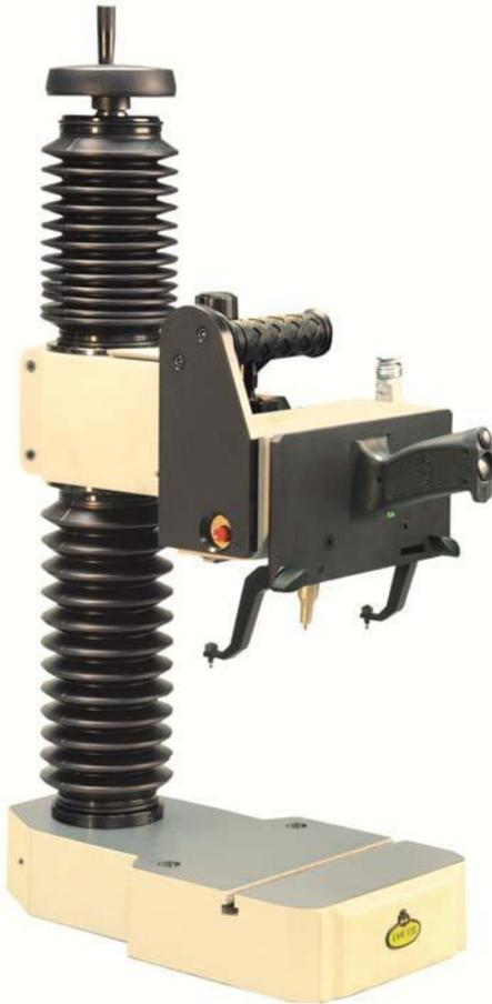
Modelo mixto de sobremesa y portátil, soportado en columna y mesa, para marcado de piezas de cualquier tipo.
