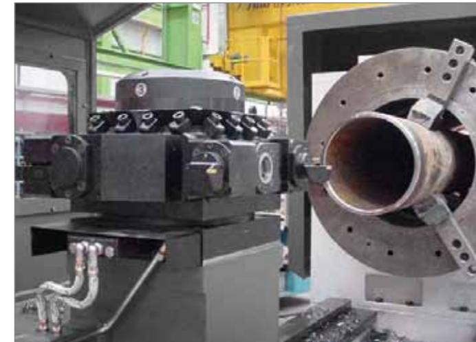
Cabezal con doble motor. Eje C con precisión 0,001°.
