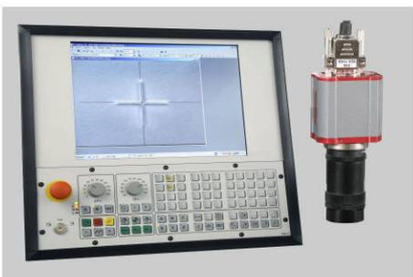
Kamera mit Fadenkreuz-Bild am Monitor
