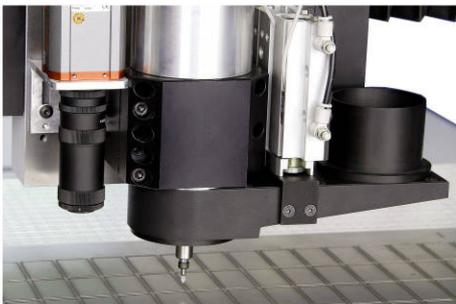
Kamera, Frässpindel und Staubabsaugung
