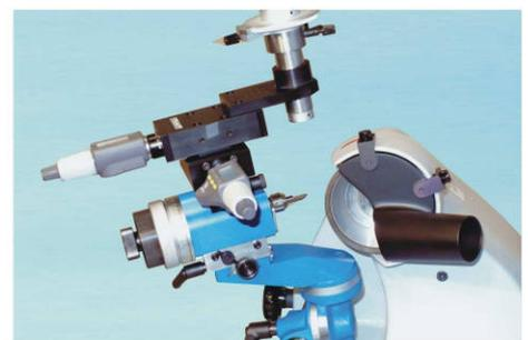
Langer Schwenkarm und langer Messschlitten für MSK
