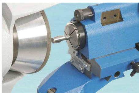
Schleifen eines Fräsers mit 2 Schneiden
