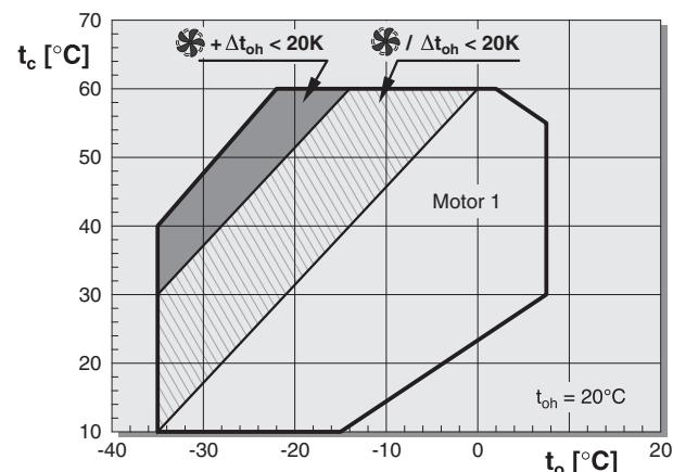
① Effektive Einsatzgrenzen der einzelnen Verdichter sind bestimmt durch max. Strom des Frequenzumrichters.
