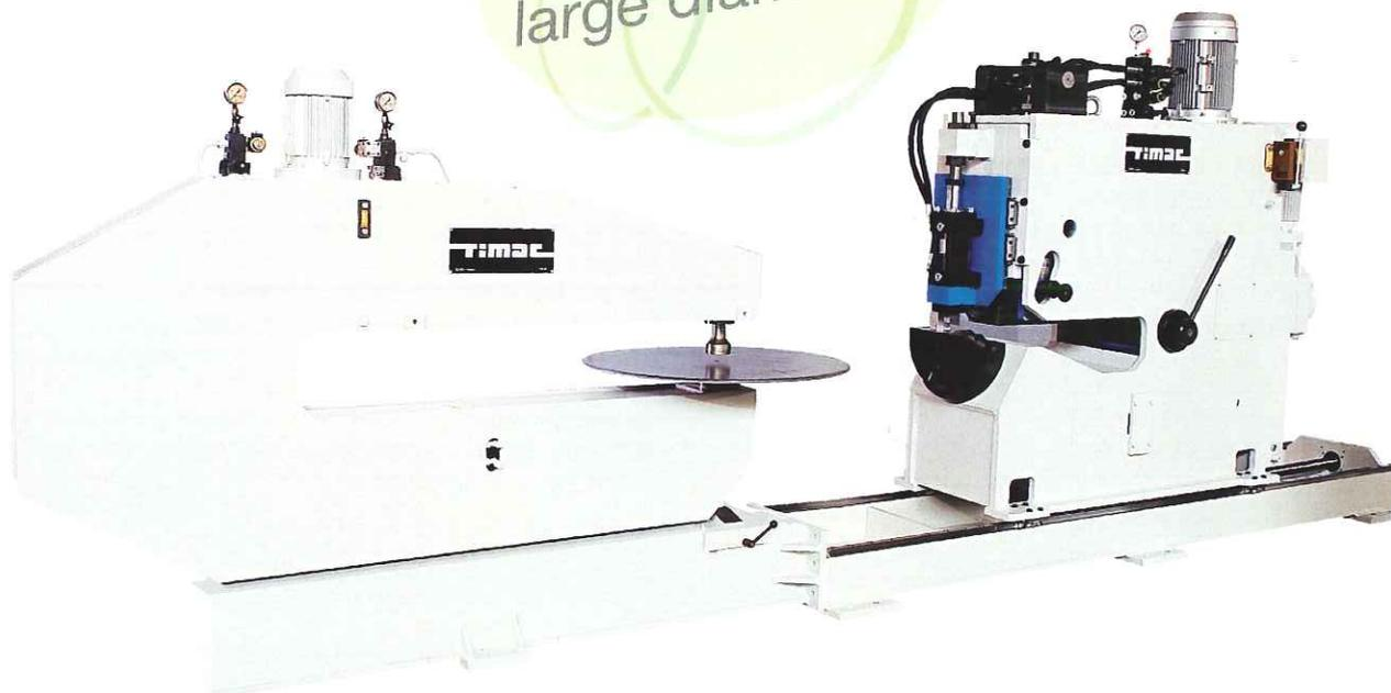
Macchina semi-automatica per il taglio di dischi e anelli piani a partire da lamiera pretagliata in quadrotto od ottagonato. Adatta per diametri fino a 3000 mm e spessori fino a 12 mm, esegue il taglio in automatico, con due velocità di 13 o 26 m/min. Il caricamento e lo scarico dei pezzi sono manuali, ma possono essere automatizzati su richiesta, al fine di ridurre i costi o aumentare gli standard di sicurezza.
