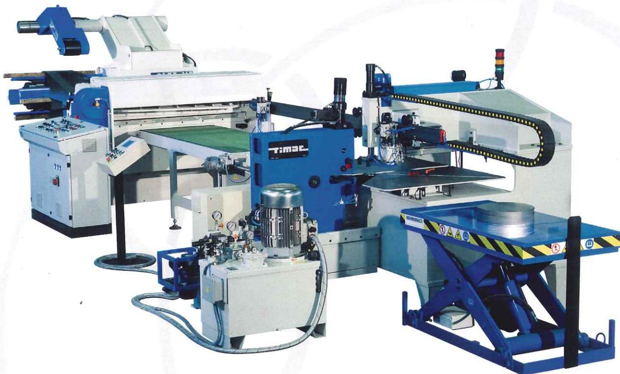
Si tratta di linee con ciclo di lavoro completamente automatizzato, dallo svolgimento della bobina di lamiera allo scarico del disco tagliato. Il nucleo della linea è composto da una cesoia circolare, che esegue il taglio dei dischi in automatico con una produzione media che va dai 140 ai 280 pezzi l'ora, diametri dai 200 ai 1600 mm e spessori dai 3 ai 5 mm, a seconda del modello di cesoia e del materiale da lavorare. Tutte le fasi di lavorazione sono controllate da PLC.
