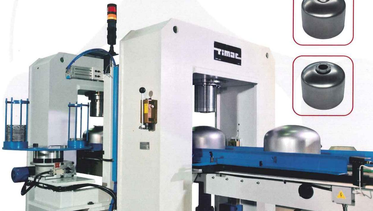
La linea esegue in automatico la tranciatura del foro assiale, l'applicazione della flangia e, su richiesta, la formatura e foratura dell'alloggiamento valvola su semigusci per vasi di espansione, con una produzione media di 240-260 pezzi all'ora.
